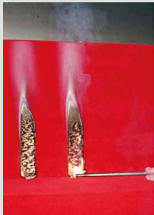
UNI 9175 – Classe 1 IM test in progress
